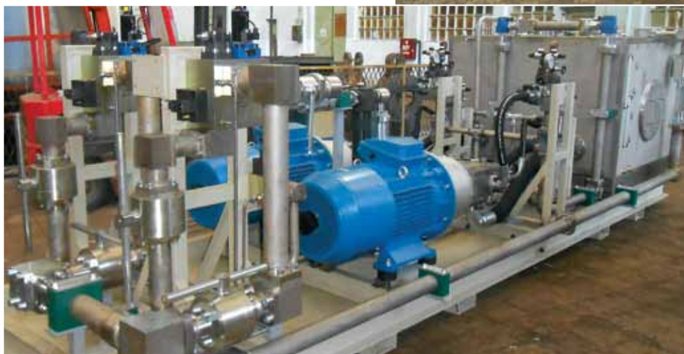
Испытание цилиндров в заводских условиях
