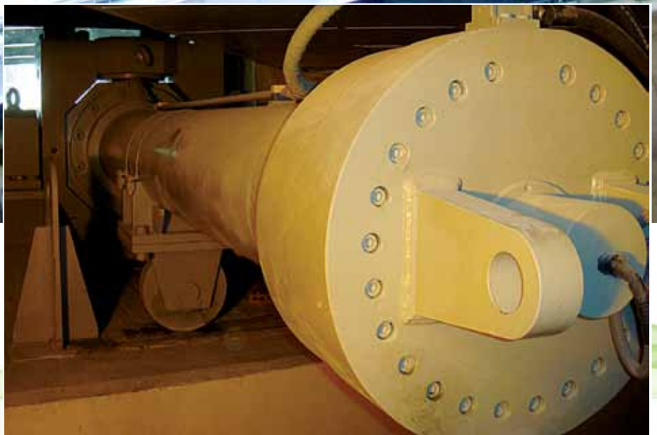
Цилиндр с траверсой для привода секторного затвора
