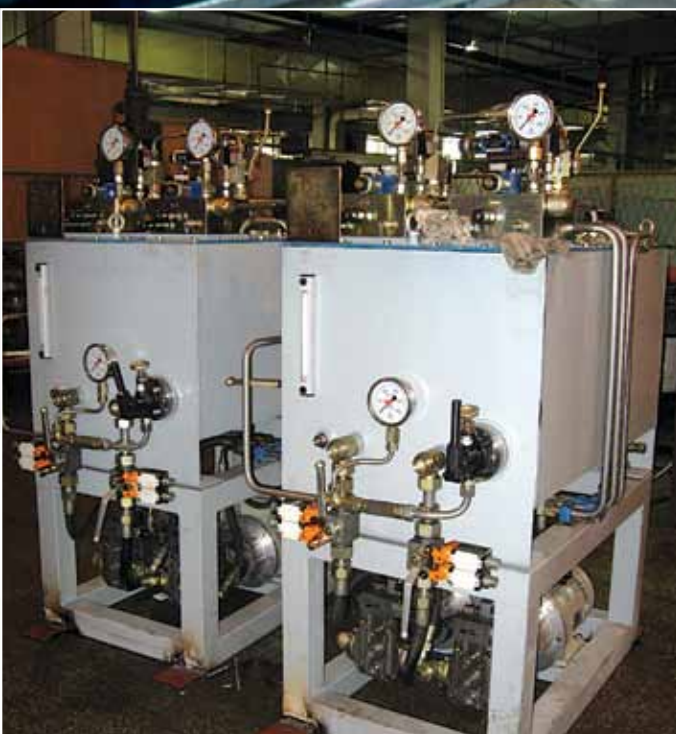
Гидравлический агрегат для привода секторного затвора
