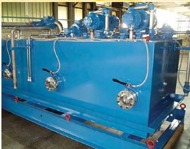
МНУ для обслуживания доменной печи
