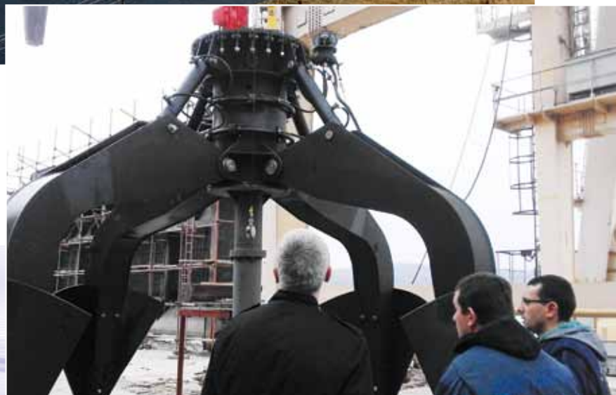
Гидравлический грейферный экскаватор на ГЭС «Джердап-2»
