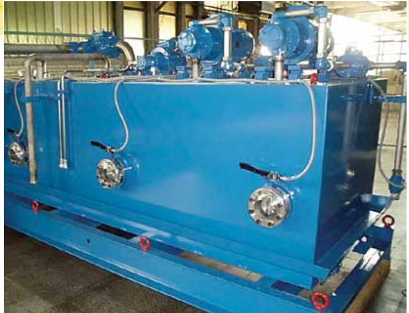
Hidraulični agregat hidrauličnog sistema za opsluživanje visoke peći
